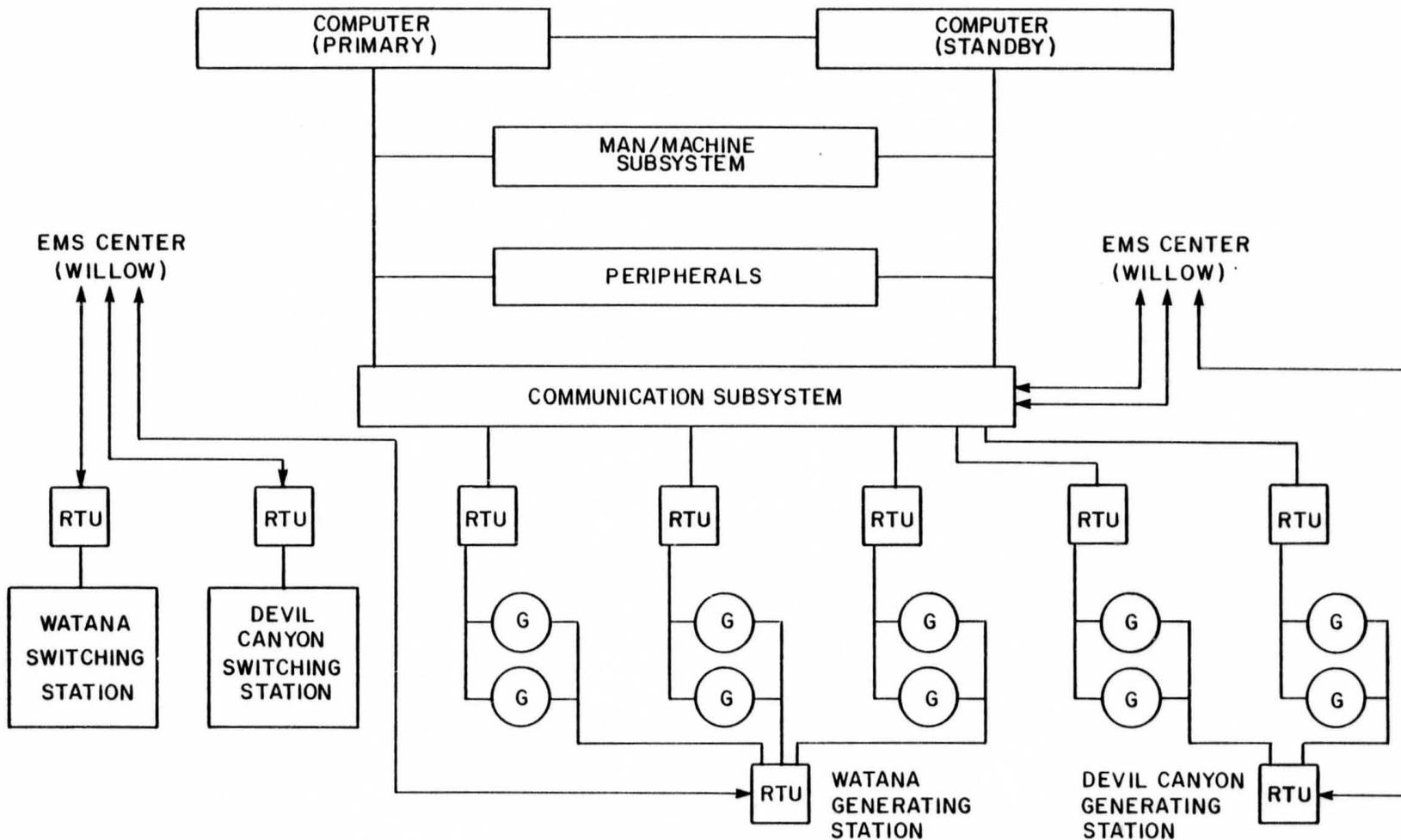
IN-PLANT MONITORING AND CONTROL SYSTEM, ALTERNATIVE II
