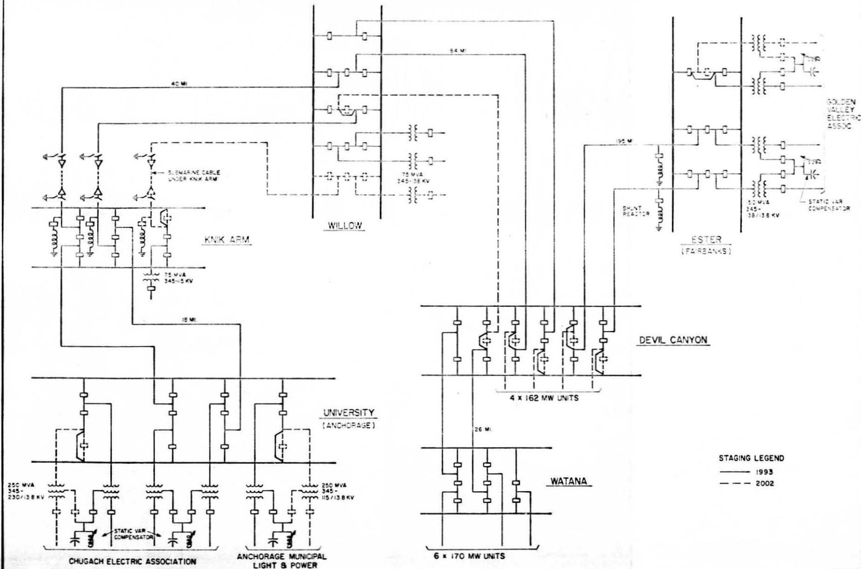
RAILBELT 345 KV TRANSMISSION SYSTEM SINGLE LINE DIAGRAM
