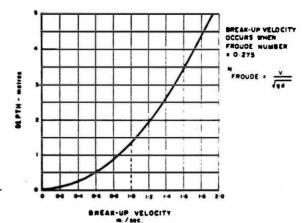
DEPTH AND BREAK-UP VELOCITY CURVE
