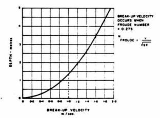
DEPTH AND BREAK-UP VELOCITY CURVE
