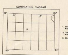
. TOPOGRAPHY FROM USGS MARSHALL DISTRICT MAP. 1:125 000, ADJUSTED TO TRIMETROGON BASE 2. TOPOGRAPHY BY PHOTOALIDADE METHODS ADJUSTED TO TRIMETROGON BASE 3. PLANIMETRY FROM TRIMETROGON COMPILATION
